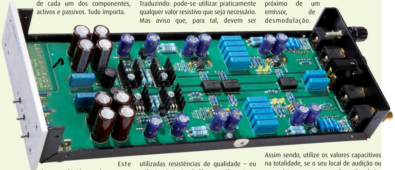
Este é, sem dúvida nenhuma, um circuito – à falta de melhor palavra – limpo. Refiro-me não só ao projecto, mas também à execução. Note-se o cuidado na escolha dos materiais para as caixas, o cabo de ligação entre a fonte e a caixa de sinal (Klotz), os electrolíticos de baixa impedância e alta temperatura, os díodos de comutação rápida, a distribuição dos planos de massa e as comutações por relés, passando ainda pelas pouco usuais bobinas de *choke* nas linhas de alimentação.
